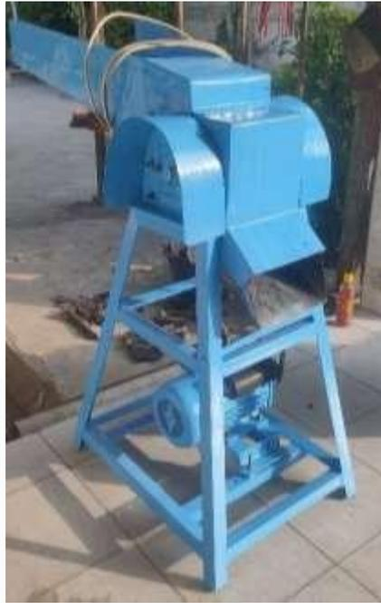
Gambar 4.8 Prototipe Mesin Pencacah
