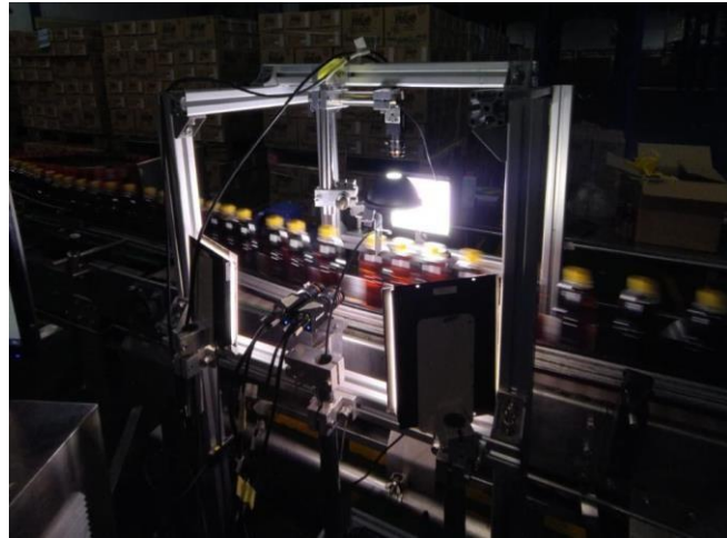
Gambar 44. Trial Camera MV-GS050-10GC-PRO di TFJ Cimande
