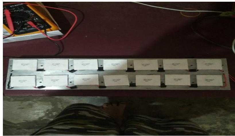
Gambar 4.18 Susunan Rangkaian TEG
