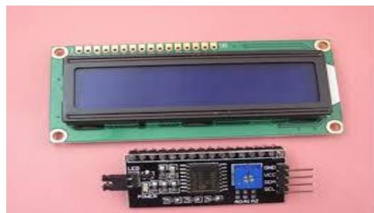
Gambar 2.11 Bentuk Modul I2C LCD [16]
