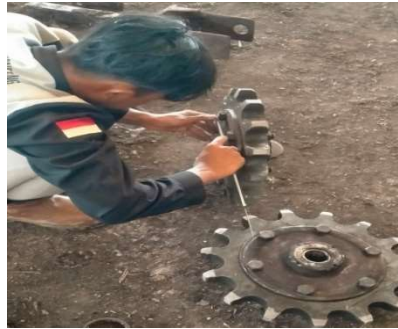
Gambar 2 Pengukuran Gear Turner
