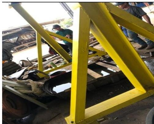
**Gambar 2.5 Besi UNP pada *gantry crane***
