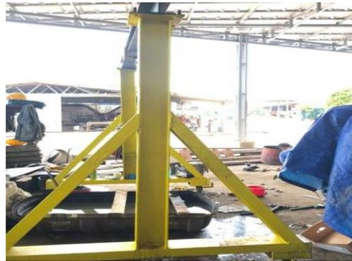
**Gambar 2.4 Besi H Beam pada *Gantry Crane***
