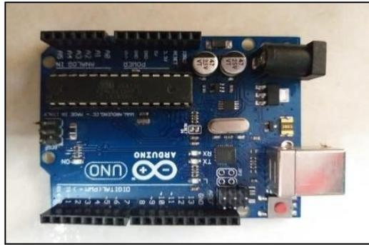
untuk komunikasi serial yang tersedia di pin digital 0 (RX) dan 1 (TX) [6]. Arduino UNO dapat dilihat pada gambar 2.4 dibawah ini.
