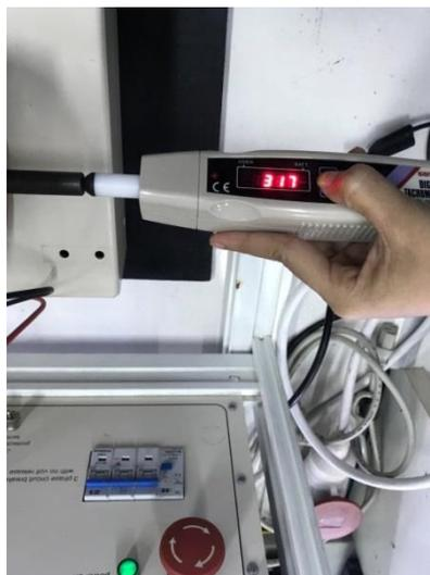
Gambar 4.6 Kecepatan (rpm) pada generator
