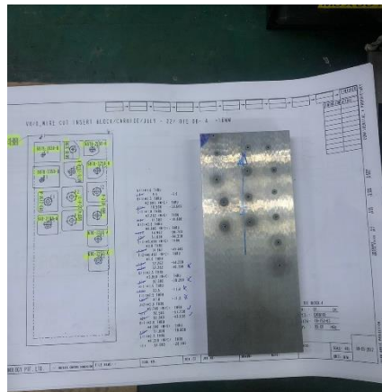
Gambar 2.5 Material yang telah memiliki hole dari mesin Super drill
