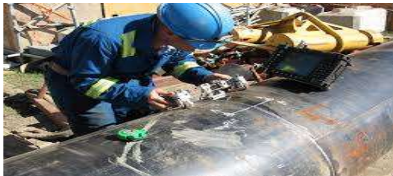
Gambar 2.8 Pemeriksaan hasil Welding Metode Ultrasonik Test
