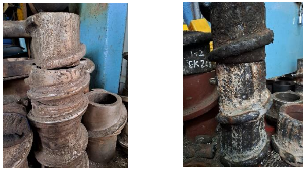
Gambar 2. 10 Worm Yang Belum Di Repair dan Sudah
