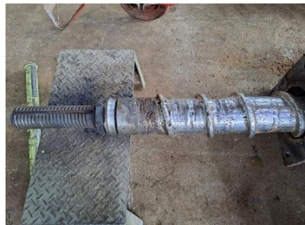
Gambar 2. 7 Worm dan Ring yang akan dikeluarkan dari poros
