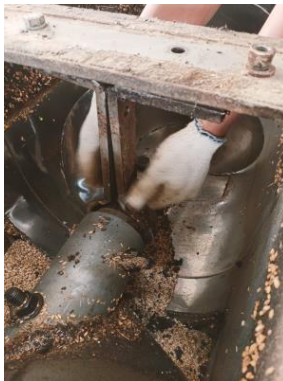
Gambar 2. 21 Mengencangkan Baut Gantungan Metal
