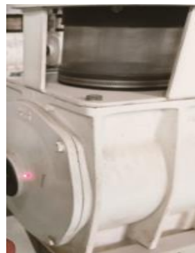
Gambar 2. 7. Mengecek kelengkapan dan kekencangan baut airlock
