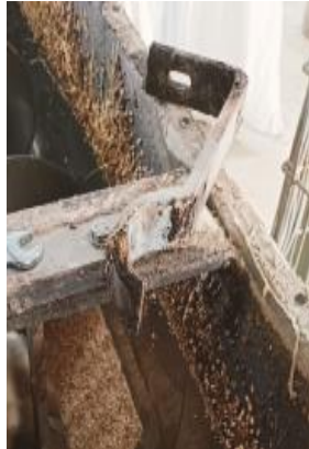
Gambar 2. 17 Melepas Gantungan Metal
