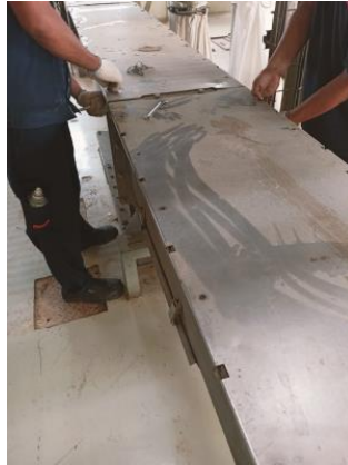
Gambar 2. 14 Membuka Baut Bodi
