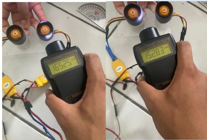
Gambar 4. 4 Gambar Motor BLDC 1,2 Dan Tachometer
