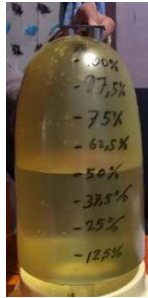
Gambar 4. 14 Pengujian Ketinggian Air Secara Manual
