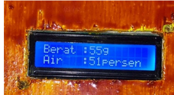
Gambar 4. 19 Hasil Pengujian Menggunakan Sensor Load Cell pada LCD
