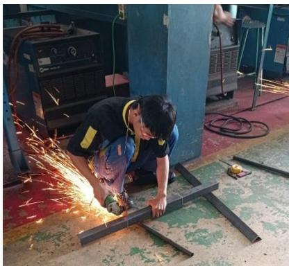
Gambar 4.2 Proses Pemotongan
