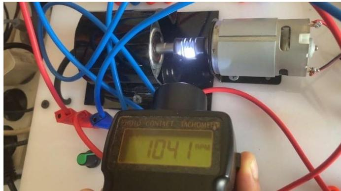
Gambar 4. 1 Perhitungan RPM dengan Tachometer
