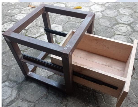
Gambar 4.2 Kontruksi Slide Laci
