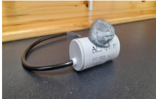
Gambar 4.3 Kerusakan Pada Kapasitor
