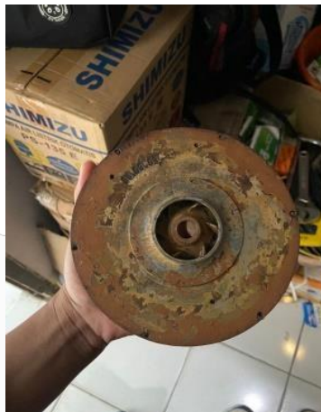
Gambar 4.1 Kerusakan Pada Impeller
