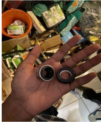
Gambar 4.2 Kerusakan Pada Seal
