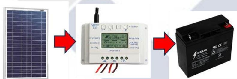
Gambar 4. 15 Pengisian Baterai Aki menggunakan *Solar cell* Cell
