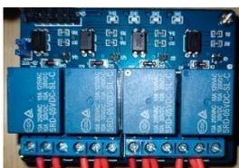
Gambar 4. 6 Pembuatan Relay 4 Channel
