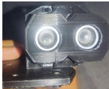
Gambar 4. 5 Pemasangan sensor ultrasonik
