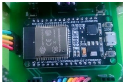
Gambar 4. 6 Pemasangan Modul ESP
