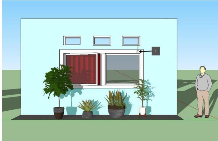
Gambar 3. 4 Penempatan Sensor LDR
