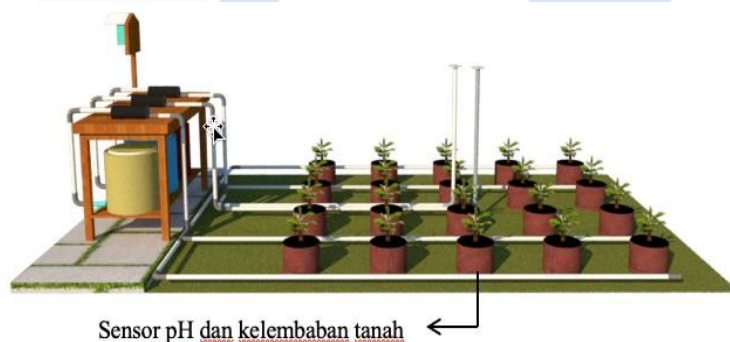
Gambar 3. 8 Sensor pH dan Kelembaban
