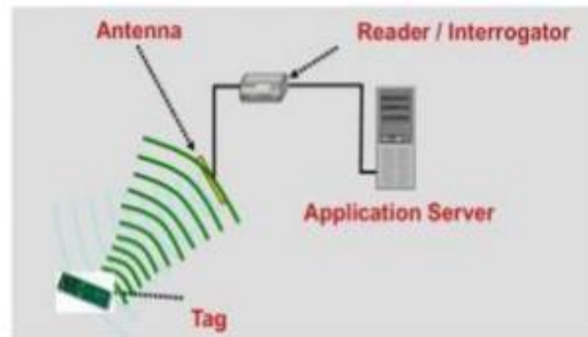
Gambar 2. 4 Diagram Sederhana Sistem RFID Secara Umum [19]
