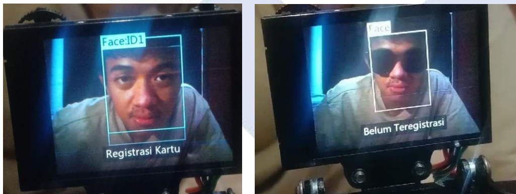
Gambar 4. 45 Hasil Pengujian Face Recognition wajah menggunakan kacamata
