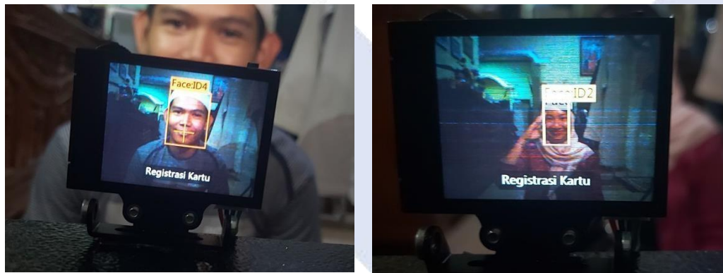
Gambar 4. 47 Pengujian Face Recognition wajah menggunakan penutup kepala
