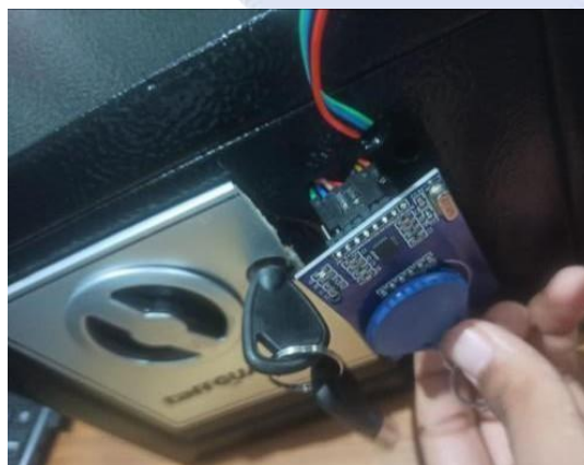
Gambar 4. 15 Pengujian RFID Key Tag pada Jarak 0 cm
