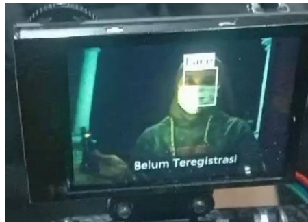
Gambar 4. 46 Pengujian Face Recognition wajah menggunakan masker
