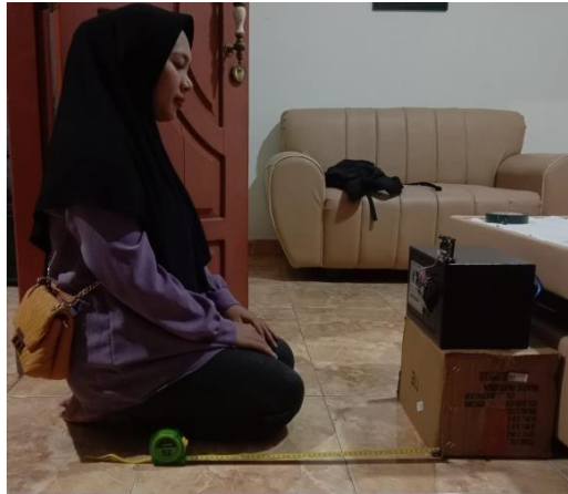
Gambar 4. 32 Pengujian Face Recognition wajah orang ke-5 Jarak 50 cm
