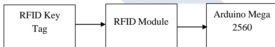
Gambar 4. 13 Diagram Blok Pengujian RFID Reader
