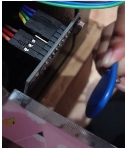
Gambar 4. 23 Pengujian RFID Key Tag pada Jarak 4 cm
