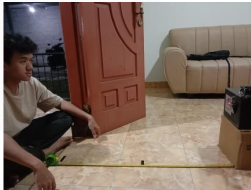
Gambar 4. 33 Pengujian Face Recognition wajah orang ke-1 Jarak 1 m
