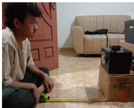
Gambar 4. 28 Pengujian Face Recognition wajah pertama Jarak 50 cm
