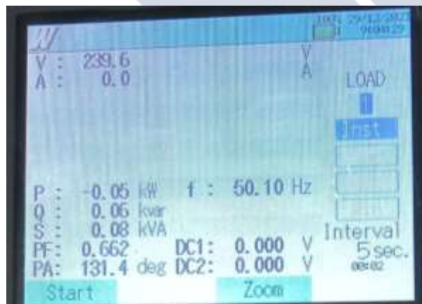
Gambar 4.6 Pengukuran pada kipas speed 3 menggunakan Power Quality Analyzer
