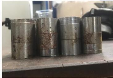
Gambar 3.7 Spesimen Uji Baja S45C
