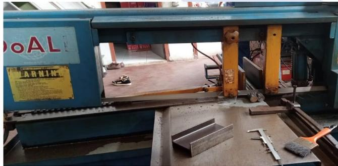
Gambar 3.2 Mesin Gergaji Potong DOALL Model C-916
