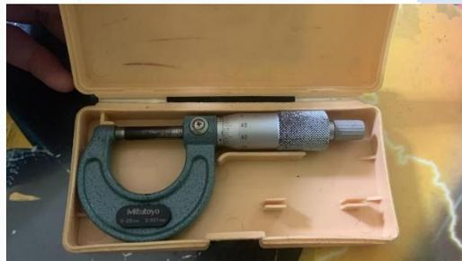
Gambar 3.6 Micrometer 0,001 mm
