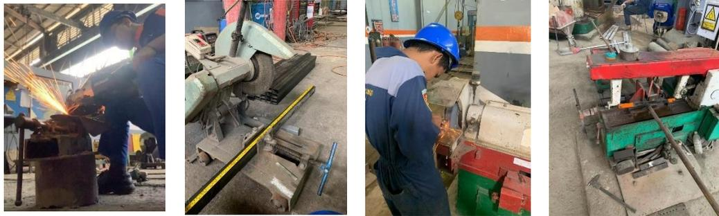
Gambar 2. 8 Mengoperasikan Mesin Gerinda, *Cutting Wheel*, dan Gergaji Mesin
