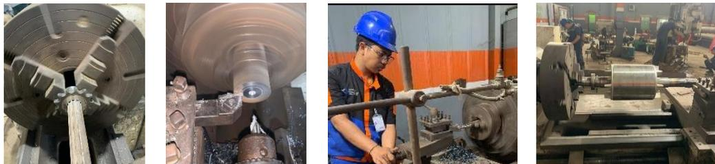
Gambar 2. 4 Melakukan Proses Pembubutan
