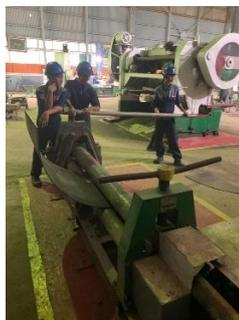
Gambar 2. 10 Mengoperasikan Mesin *Bending*
