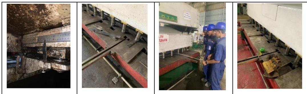
Gambar 2. 7 Mengoperasikan Mesin *Cutting Plate*
