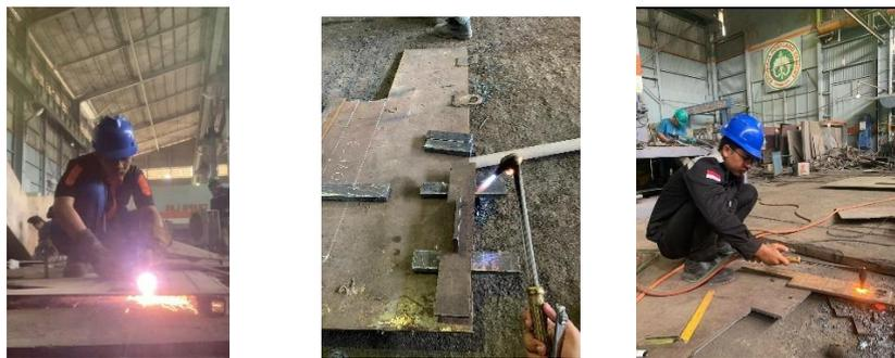
Gambar 2. 12 Mengoperasikan *Torch Cutting*
