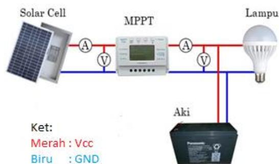
Gambar 4.40 Skematik Pengukuran Solar Cell
