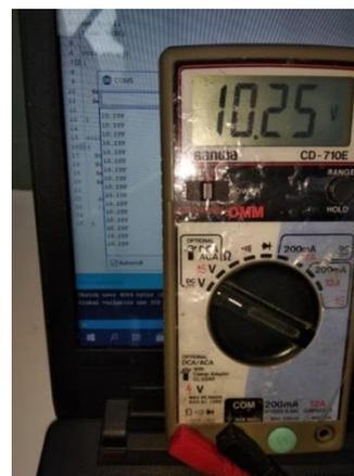
(b) Pengujian Sensor Tegangan 2
