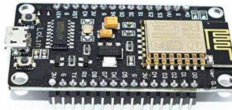
Gambar 2.6 Fisik Modul NodeMCU
