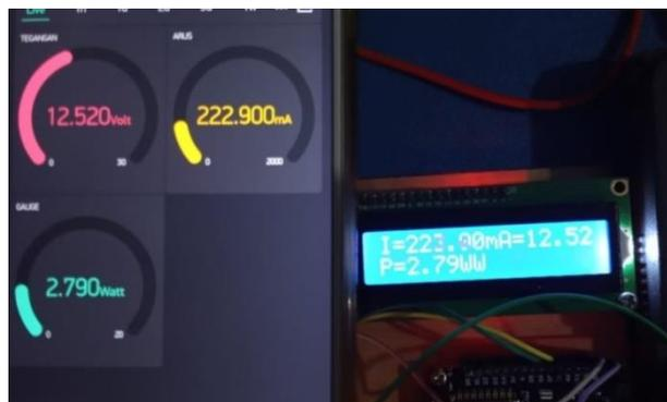
Gambar 4.12 Pengujian 1 Sensor INA 219 Terhadap Alat Ukur Multimeter
