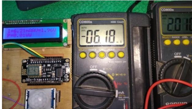
Gambar 4.13 Pengujian 2 Sensor INA 219 Terhadap Alat Ukur Multimeter
