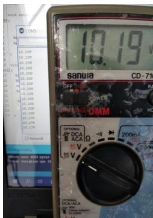
(a) Pengujian Sensor Tegangan 1
