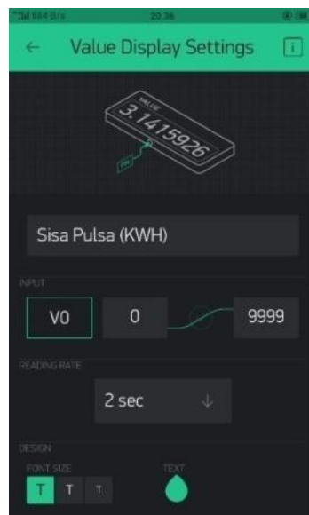
Gambar 4.35 Perancangan virtual tampilan pulsa kWh di smartphone
