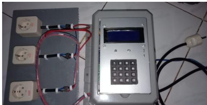
Gambar 4.5 Hasil pembuatan konstruksi perangkat keras kWh meter Prabayar
