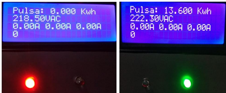
Gambar 4.31 Hasil pengujian led indikator
