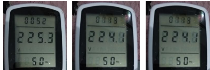
Gambar 4.19 Pengukuran sensor PZEM-004T terhadap tegangan beban tampilan di Wattmeter Digital
