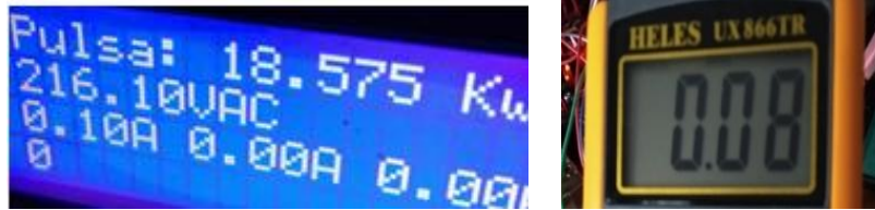
Gambar 4.14 Pengujian sensor arus terhadap beban cas laptop
