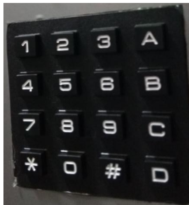
Gambar 4.24 Pemasangan keypad 4x4
