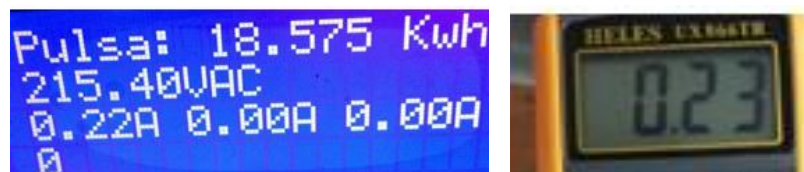
Gambar 4.13 Pengujian sensor arus terhadap beban kipas angin
