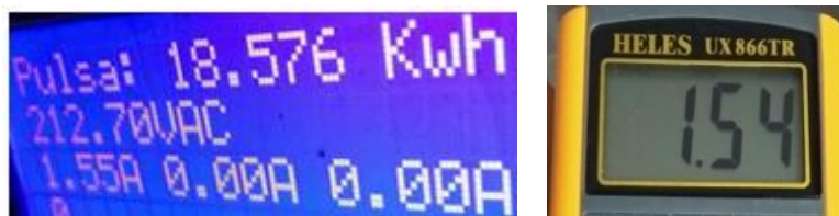
Gambar 4.15 Pengujian sensor arus terhadap beban setrika
